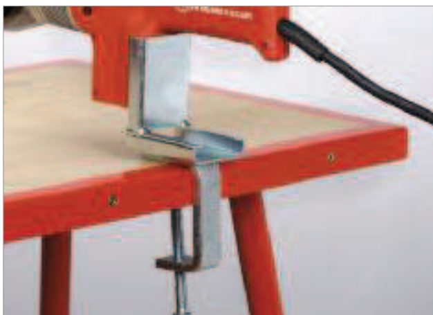
Fissaggio dell'apparecchio al banco di lavoro. Presa sicura.
